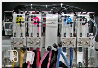
Sistema de presión negativa. Proporcionan mayor alimentación de tinta a los cabezales, permitiendo mas velocidad de impresión.
