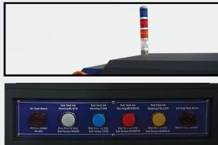
Panel que te indica cuando hay un bajo nivel de tinta en los tanques y subtanques.
