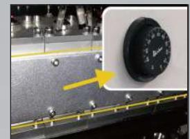
Control de temperatura de tinta variable.
