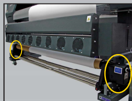
Sistema take-up automático con 2 motores sincronizados de tensión constante ajustable.
