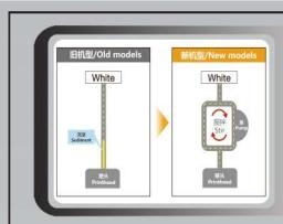
Sistema Agitador automático 1 por color para prevenir separación de Tinta.
