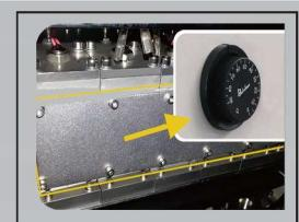
Control exacto de la temperatura de la tinta optimizando el curado de tinta.
