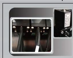
Las válvulas de cierre de tinta manual ahora se reemplazan con válvulas de tinta tipo solenoide automáticas.
