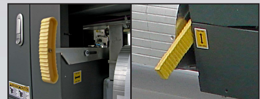
2 palancas, adelante y atrás, que facilita el montaje del material.
